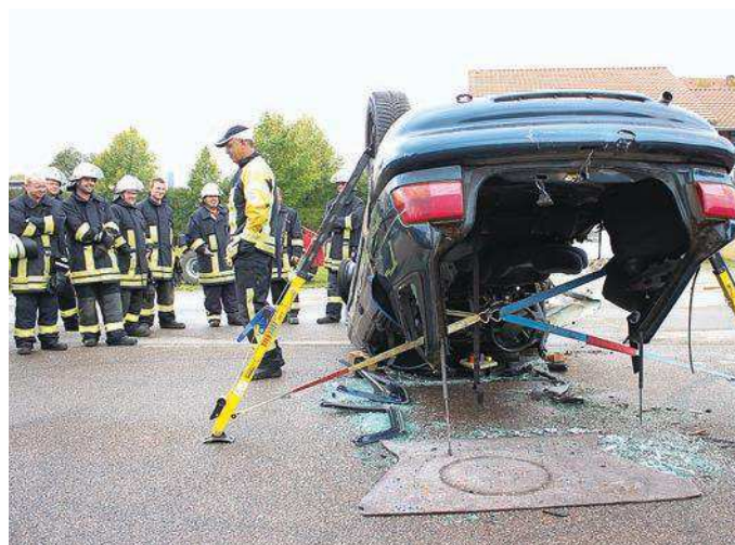
Auch ohne Dach steht das Auto durch die Stabilisierung sicher.
