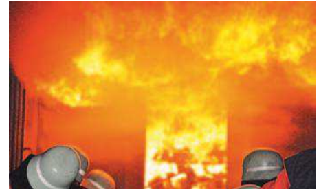
Wenn sich der heiße Rauch entzündet, kommt es zu einer Feuerwalze an der Decke. In einem Container können die Atemschutzgeräteträger diese Situation realitätsnah erleben. Bild: I.F.R.T.
